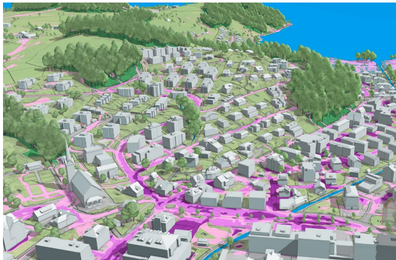
Abb. 5: Strassen sind oft bevorzugte Fliesswege, wie dieses Beispiel der Gemeinde Horw zeigt. Die 3D-Ansicht hilft, eine erste Plausibilisierung der Gefährdungskarte vorzunehmen und mögliche Lösungen zu antizipieren.
