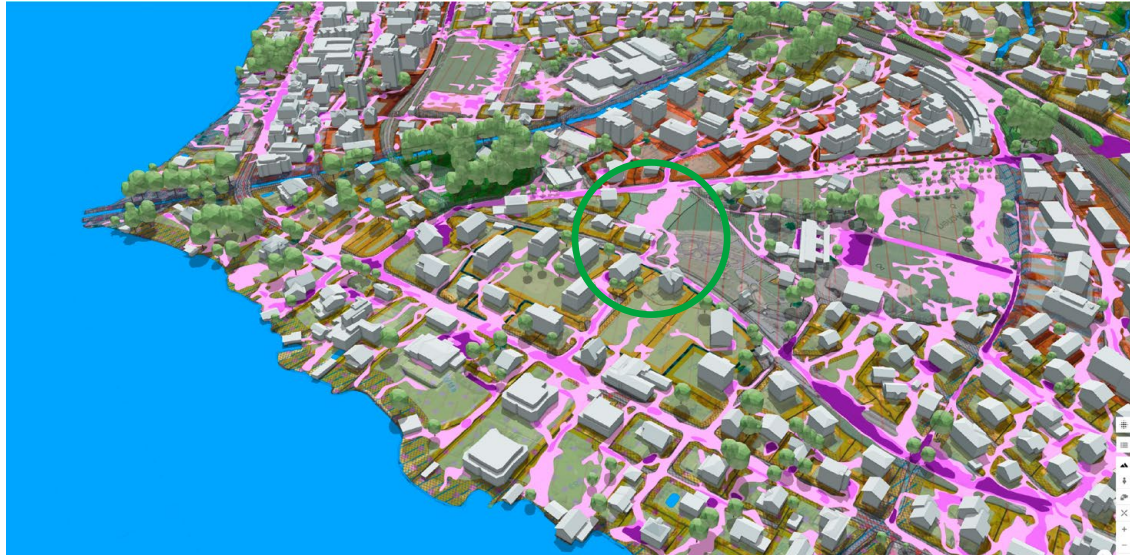
Abb. 3: Gemeinde Hergiswil mit überlagerter Darstellung der Gefährdungskarte «Oberflächenabfluss». Solche Analysen und Visualisierungen ermöglichen essentielle Erkenntnisse in der strategischen Planungsphase eines Projekts.
